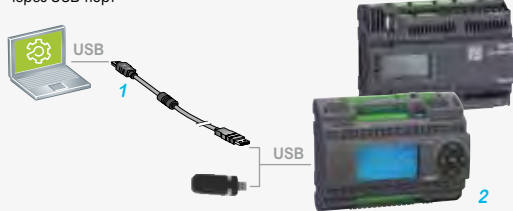
Локальное программирование, загрузка через USB-порт
