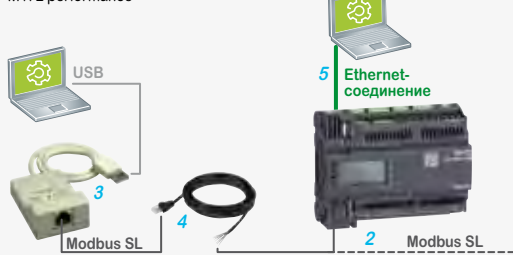
Локальное программирование, загрузка - M171 optimized - через TTL порт
